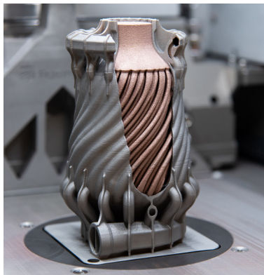
Abb. 1: additiv hergestellter Wärmeaustauscher des Fraunhofer IGCV
